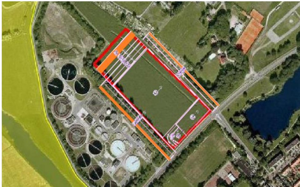
Modelberekening lichtintensiteit (waarden in Lux). De oranje vlakken zijn de delen met een grenswaarde van 0,25 lux. (Bron: Infralux, 2013)
