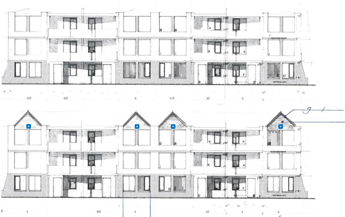
Figuur 17. Oorspronkelijke situatie (boven) en ontwerp permanente voorzieningen (onder) van het appartementencomplex, zie ook Figuur 12. De ruimte onder het dakbeschot is functioneel als verblijfplaats van laatvlieger. Openingen in de kopgevel (blauw) zorgen voor een extra uitvliegmogelijkheid en de mogelijkheid om de loze ruimte in het dak te gebruiken als verblijfplaats.
