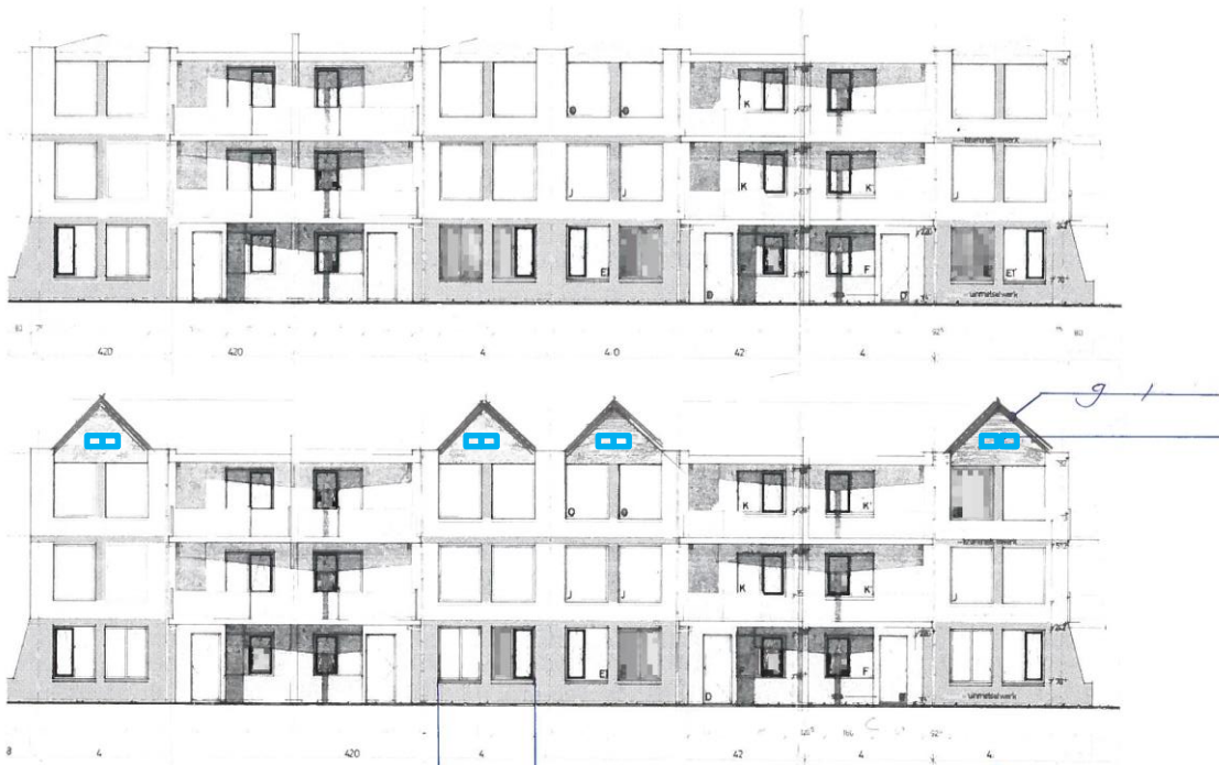
Figuur 15. Oorspronkelijke situatie (boven) en ontwerp permante voorzieningen (onder) van het appartementencomplex, zie ook Figuur 12. Per kopgevel worden twee permanente voorzieningen (neststenen) voor gierwaluw ingebouwd (blauw).
