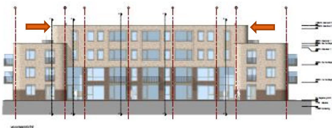
Figuur 20 Nieuwbouw binnen het plangebied. Locatie binnen het gebouw met loze ruimte, zie pijlen. Hier kunnen mogelijk verblijfsmogelijkheden voor vleermuizen gecreëerd worden.
